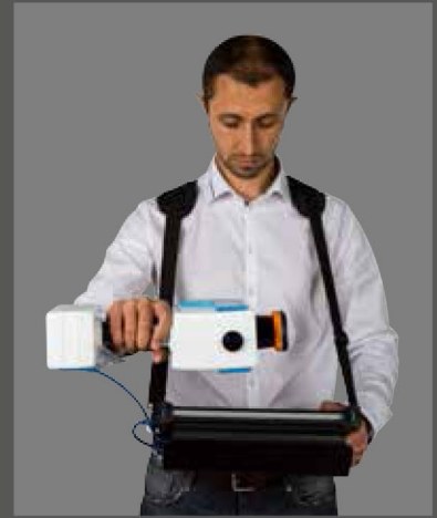
垂直剖面通过手动按钮触发，无需通过屏幕交互
