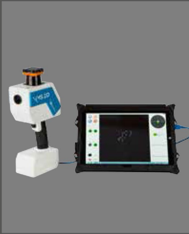
iMS2D 捕获设备包括一个激光传感器，一个惯性测量单元和一个鱼眼相机，一个平板电脑和一个外壳
