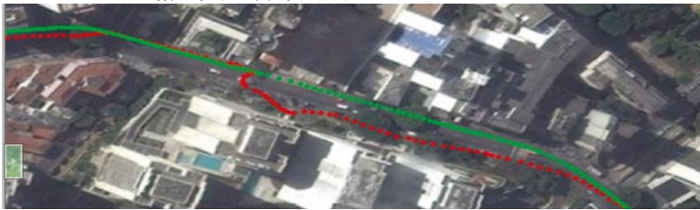
在城市峡谷多路径缓解, 独立 GPS - 红色路径; GPS + 惯性测量装置 - 绿色路径
